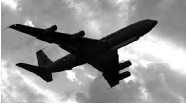
JSTARS. Det konverterede Boeing 707-fly, der er kendt som JSTARS, indsamler og kombinerer radar-, infrarød- og video-information og opretter aktuelle elektroniske landkort til brug for USA's øverstkommanderende på slagmarken.
